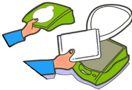
Der Gerätedeckel kann auch als System zur passiven Unterstützung der Atemwege verwendet werden.
